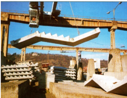
Obr. 22 Manipulační úchyty prefabrikátů – příklady vyráběných prvků
