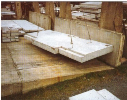
Obr. 23 Ukázky prefabrikovaných schodišťových prvků
