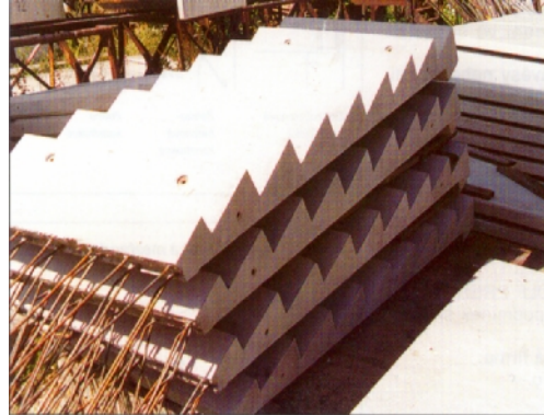
Obr. 23 Ukázky prefabrikovaných schodišťových prvků
